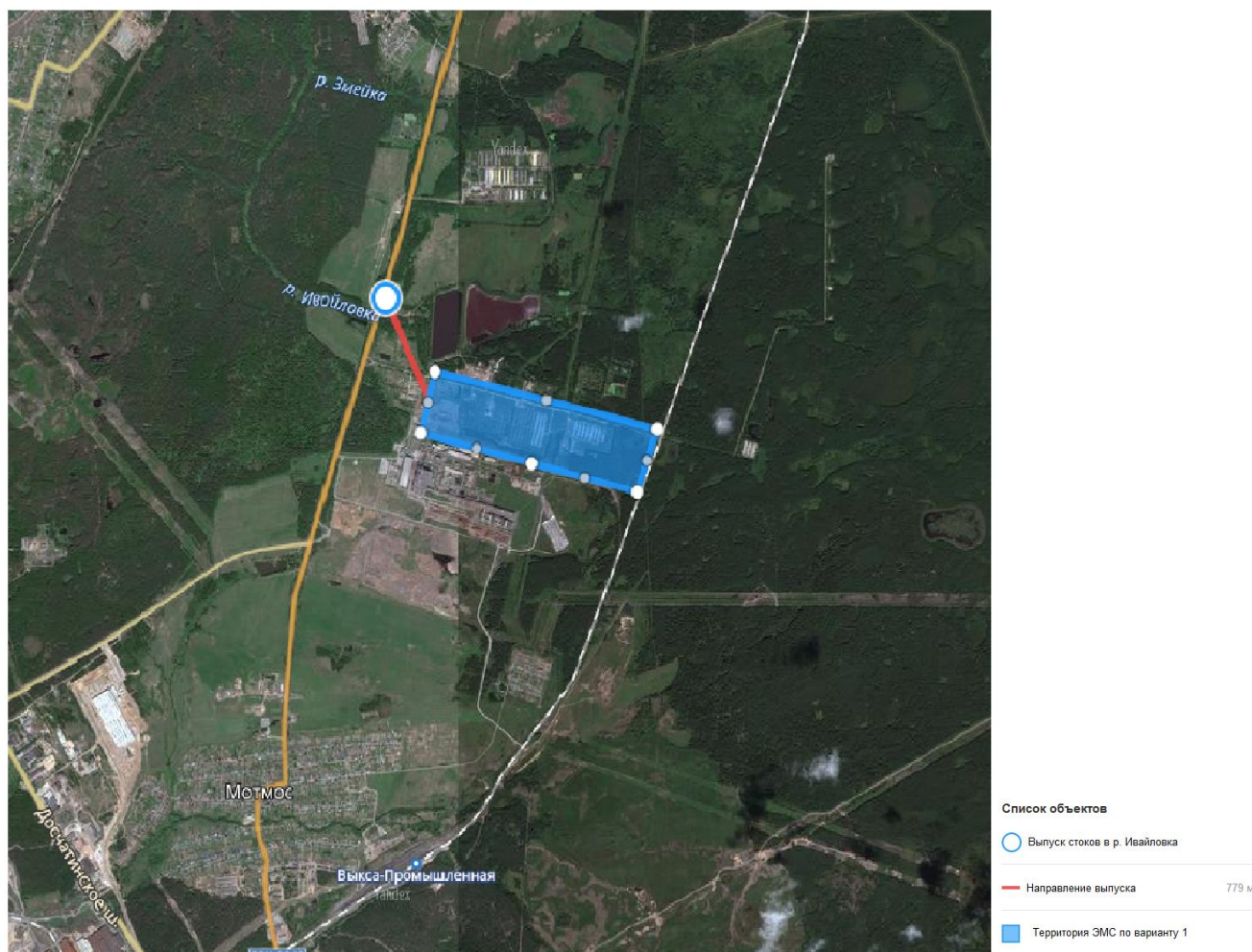
Рисунок 6.1- Схема организации выпуска стоков ЭМК в р. Ивайловка при размещении объекта по варианту 1
